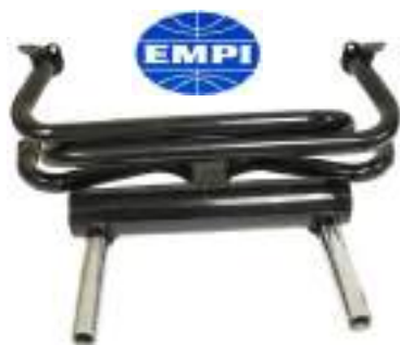
23 167 échappement Sport 13/1600cc avec sorties chromées comme origine
