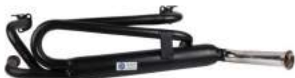
23 247 échappement sport avec silencieux rond "OEM MOTORSPORT" 13/15/1600cc
